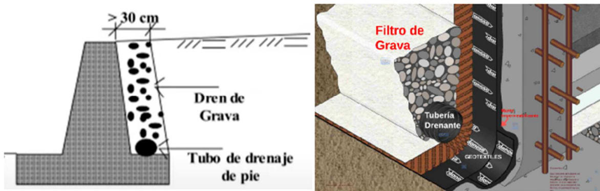
Drenaje de muros de contención de dren de pie con filtro de grava y geotextil.
